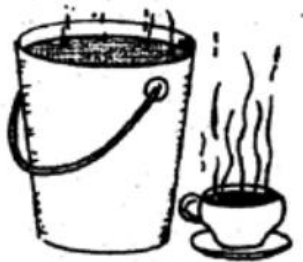
Fig. 7.3. El agua en el balde tiene mayor capacidad térmica (Inercia térmica) que el agua en la taza.
