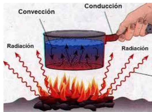
Fig.7.2 El calor fluye de la región de mayor temperatura a la de menor temperatura
