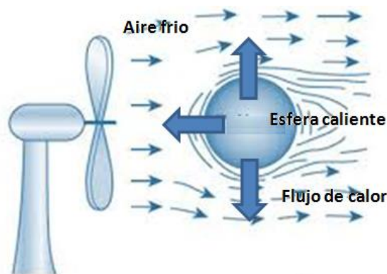
Fig.7.18. Movimiento por conveccion forzada.
