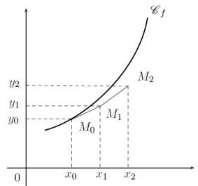
On recommence le procédé en posant  $x_2=x_1+h$ , et en approchant  $f(x_2)$  par l'image de  $x_2$  sur la tangente à  $C_f$  au point  $M_1$ .
