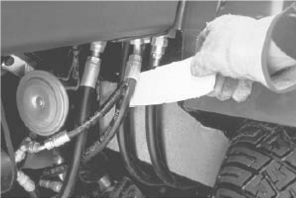
Cuando reemplace una manguera hidráulica, procure que la manguera quede derecha (no presente giros) antes de apretar los conectores. Puede hacerlo observando la línea marcada en la manguera. Con dos llaves de tuerca; mantenga derecha la manguera con una y con la otra apriete la tuerca del eslabón giratorio del conector. Siga los procedimientos ilustrados en el Manual de Servicio de Mangueras Hidráulicas Toro, No. De Parte 94813SL.
