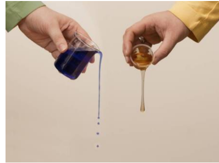
Fig.5.16. La miel cae más rápidamente que el agua (oscura) por efectos de la viscosidad.
